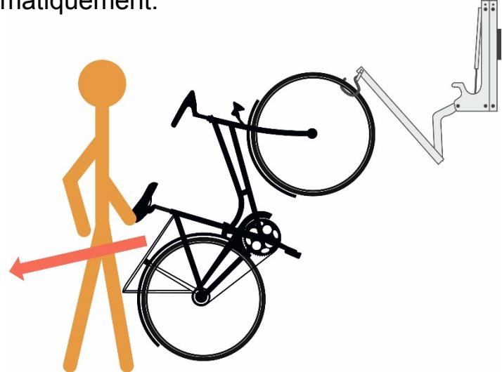
3. Pour prendre le vélo suspendu, il suffit simplement de l'abaisser en s'aidant de la selle jusqu'à ce que le bras élévateur soit en position basse.
